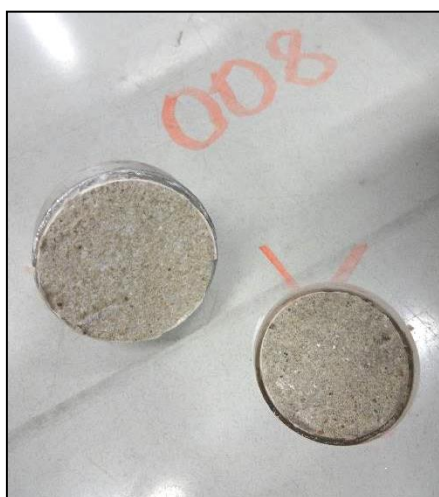
▲ F5. att. Tipiska aina pēc testa: — vietā "008" atrāvums realizējies seguma pamatnē, t.i., betonā
