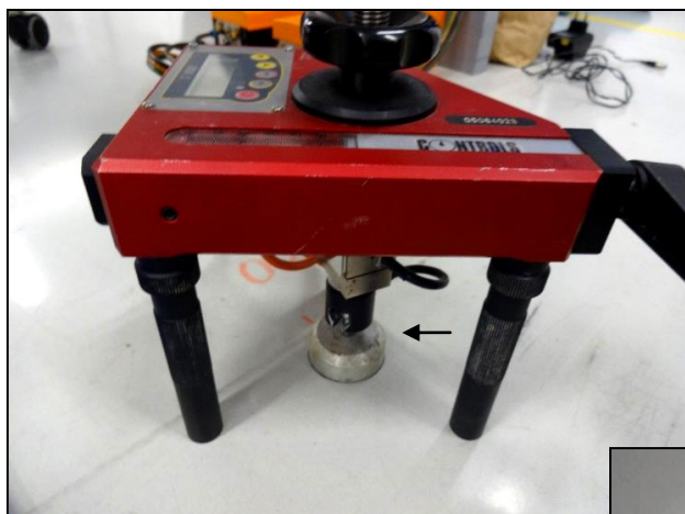
F4. att. ▶ Testa rezultāts vietā "001": — disks ar daļu no grīdas struktūras atrauts, mērierīces displejā redzams atraušanas robežspēks 5,077 kN
